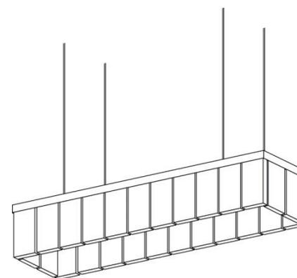
Beispiel für die Kombination von mehreren Casino-Elementen. Der CASINO kann in unterschiedlichen Formen produziert werden. Breite des Basiselements 93 mm.
