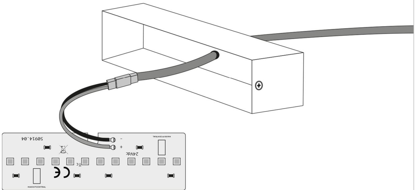
Montageanleitung für den Austausch des LED-Moduls
